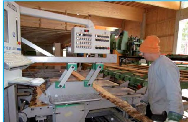
Abb. 11: Durchlaufkappsäge
