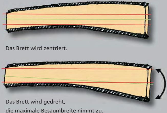
Abb. 6: Werkstücke werden nicht einfach zentriert sondern gedreht
