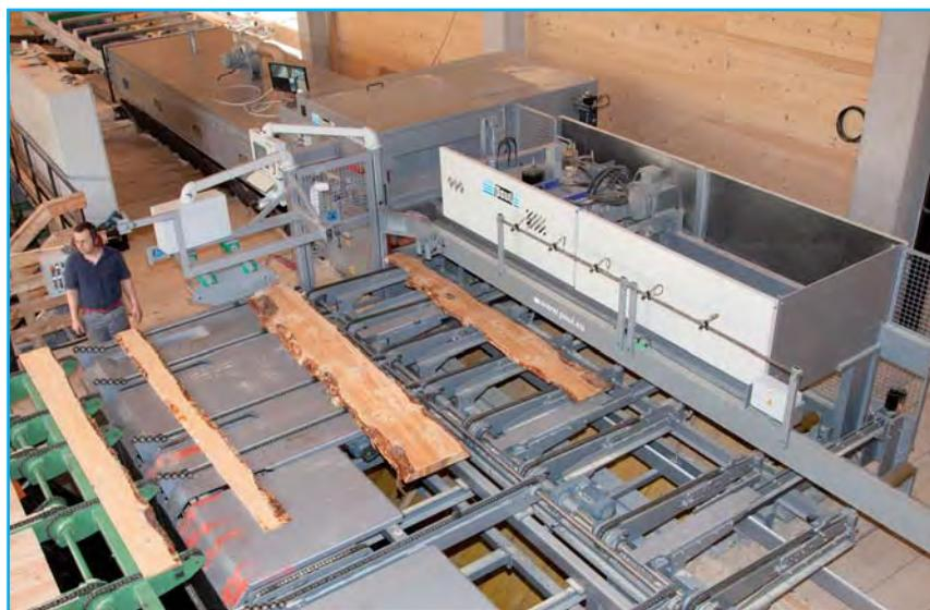
**Abb. 2:** POWER\_RIP mit AB920-XL und SGL-1518 im Sägewerk
