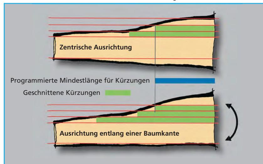
Abb. 7: Es gibt zwei Ausrichtverfahren für automatische Beschickungssysteme
