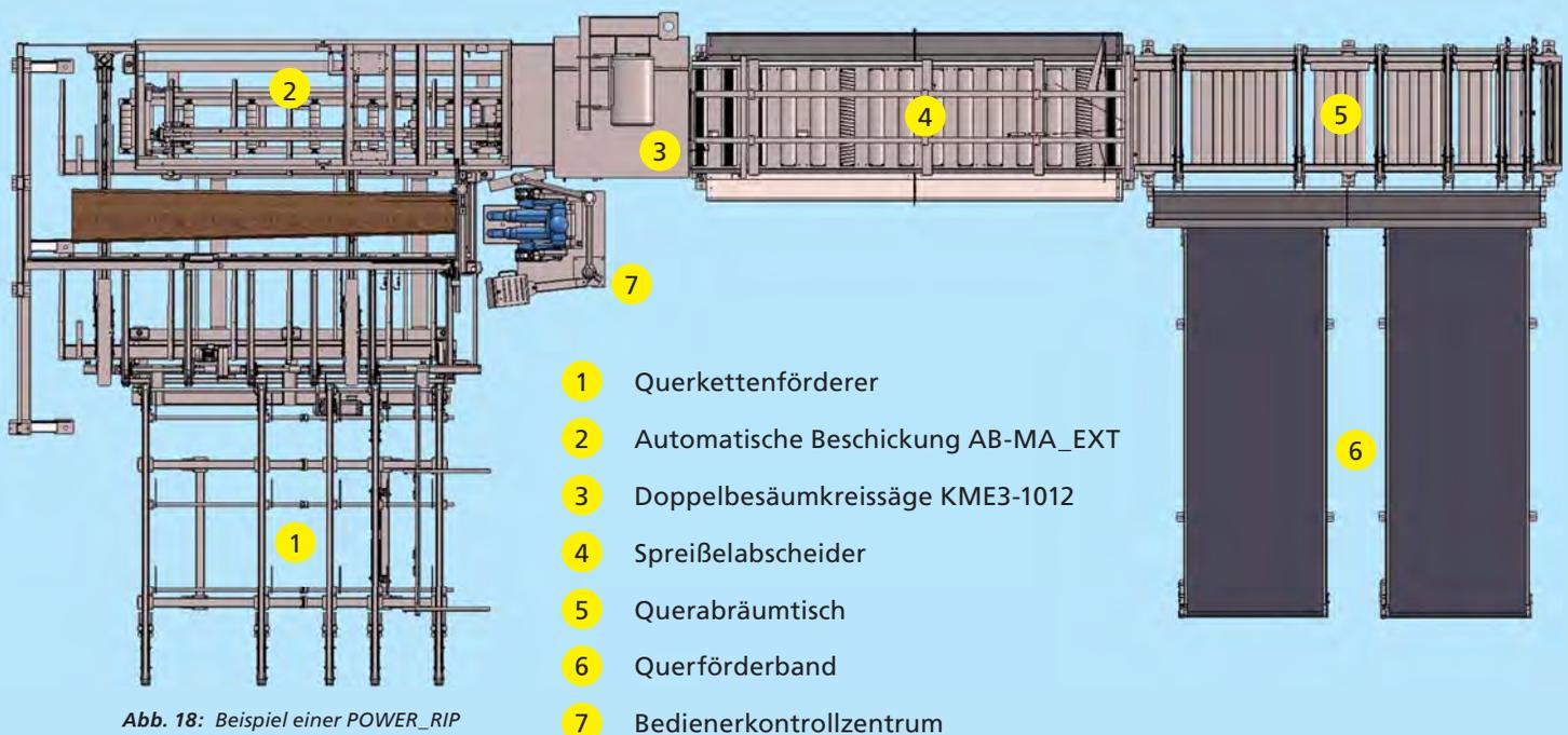
Abb. 18: Beispiel einer POWER\_RIP mit AB-MA\_EXT
