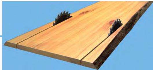
**Abb. 23:** Besäumen der Brettware in der Besäumkreissäge
