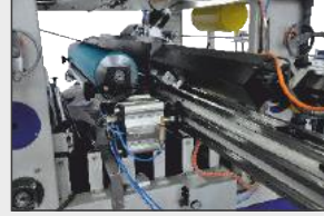
TUTKAL APLİKASYON KAFASINA UYGUN DONANIMDA TELESKOPİK BRAKET TELESCOPIC BRACKET WITH COMPATIBLE EQUIPMENT FOR ADHESIVE APPLICATION HEAD ТЕЛЕСКОПИЧЕСКАЯ ПЛАТФОРМА ДЛЯ ДЮЗЫ НАНЕСЕНИЯ КЛЕЯ
