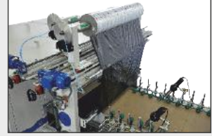
KAPLAMA SONRASI KORUYUCU BANT KAPLAMA İSTASYONU AFTER WRAPPING PROTECTIVE TAPE LAMINATING STATION УЗЕЛ НАНЕСЕНИЯ ЗАЩИТНОЙ ПЛЕНКИ ПОСЛЕ ЛАМИНАЦИИ
