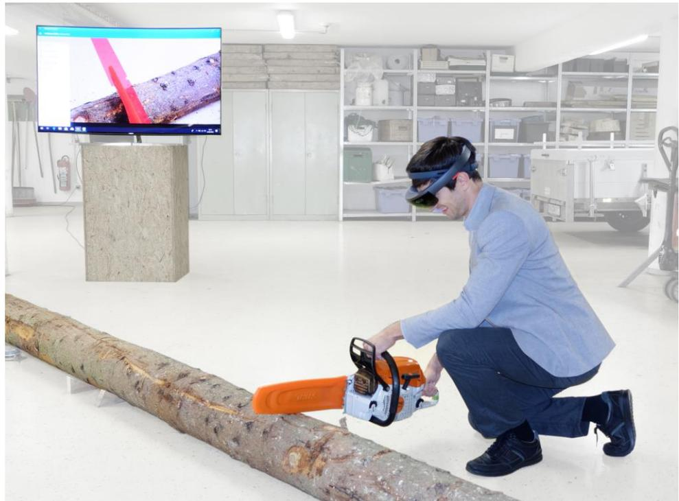
**Die Brille zeigt, wo die Säge ansetzen soll:** Der Monitor im Hintergrund zeigt das Bild aus der Brille des Motorsägenbedieners. Diesem werden die Schnittmarken der einzelnen Sortimente am realen Baumstamm angezeigt, so dass die Bearbeitung passgenau und ohne manuelles Vermessen für eine konkrete Bestellung erfolgen kann.
