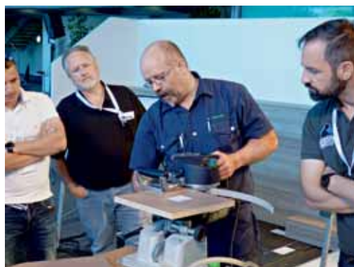
Erfahrene Anwendungstechniker zeigen, wie es geht: (hier erklärt Schreinermeister Thomas Kurz das Anbringen einer Kante mit der „Conturo KA 65“ von Festool).
