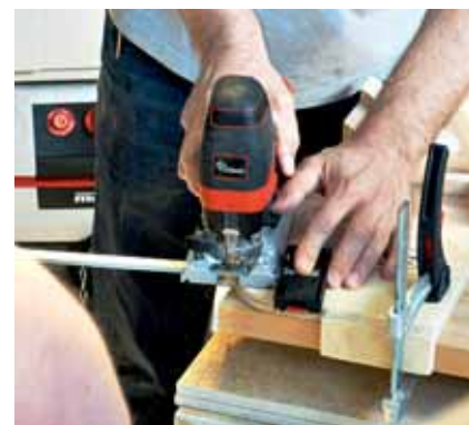
Gewusst wie: Mit der richtigen Schablone lassen sich gleichmäßige Rundungen mit der Stichsäge herstellen.
